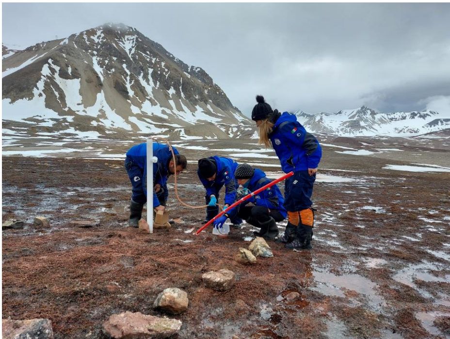
Prelievo di acque di fusione nell'"active layer" (da sx a dx, Alessandro Ciro Rappazzo, Francesca Spataro (ISP-CNR), Ilaria Baneschi (IGG-CNR) e Jasmin Rauseo (ISP-CNR)).
