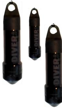
Monitoraggio in continuo di: livello idrometrico (portata), temperatura e conducibilità elettrica ("salinità") dell'acqua (*in collaborazione con il ministero dell'ambiente della Norvegia*)
